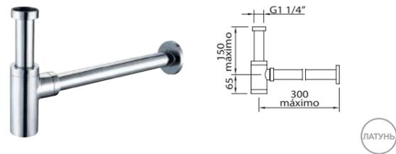
Сифон 1 1/4" для раковин, горизонтальная труба 300 мм, вертикальная труба 150 мм, труба Ø32 мм
