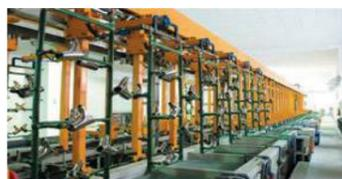
Хромирование Extra класса, наш процесс хромирования состоит из 44 различных этапов для гарантированной антикоррозионной стойкости. Хромированная поверхность должна противостоять лабораторному тесту, > 200 часов в солевом тумане без образования каких-либо дефектов.
