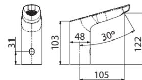
Бесконтактный кран с антивандальным аэратором, монтажный блок (60741), гибкие подводки
