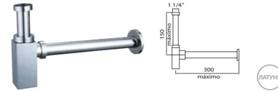
Сифон 1 1/4" для раковин, горизонтальная труба 300 мм, вертикальная труба 150 мм, труба Ø32 мм
