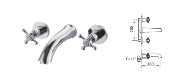
Смеситель с аэратором 1/2", встраиваемый излив 180 мм
