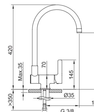
Один регулятор для питьевой и проточной воды
