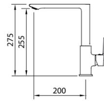
Смеситель с аэратором, поворотный излив, гибкие подводки M-10 3/8" x 420 мм
