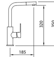
Смеситель с аэратором, поворотный излив, гибкие подводки M-10 3/8" x 370 мм
