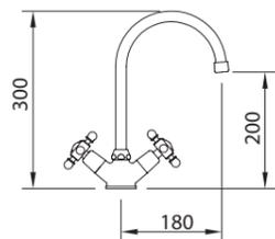
Смеситель с аэратором, поворотный излив, гибкие подводки M-10 3/8" x 370 мм
