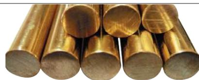
Высококачественная европейская штампованная латунь. Соответствует нормам UE EN 12.164 / 15. Штампованная латунь имеет высокий процент содержания меди (Cu ~ 60%), а также низкий процент олова (Sn < 0,3%), что позволяет избежать возможных повреждений.
