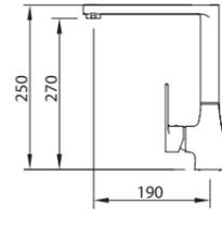
Смеситель с аэратором, поворотный излив, гибкие подводки M-10 3/8" x 370 мм
