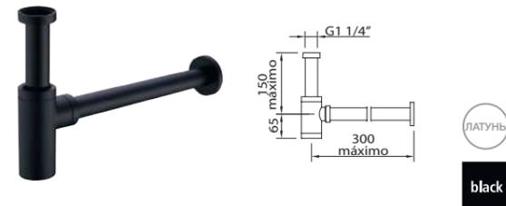
Сифон 1 1/4" для раковин, горизонтальная труба 300 мм, вертикальная труба 150 мм, труба Ø32 мм
