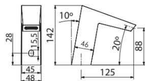
Бесконтактный кран с антивандальным аэратором, монтажный блок (60741), гибкие подводки
