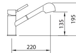
Смеситель с аэратором, поворотный выдвижной излив с гибкой подводкой, гибкие подводки M-10 3/8" x 370 мм
