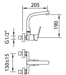
Настенный смеситель для мойки с аэратором, высокий поворотный излив
