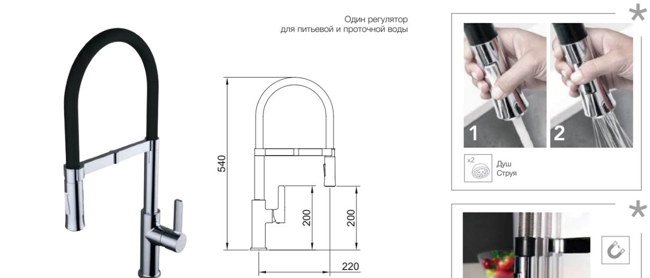
Один регулятор для питьевой и проточной воды
