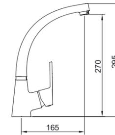
Смеситель с аэратором, поворотный излив, гибкие подводки M-10 3/8" x 370 мм
