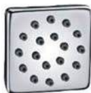
Регулируемые гидромассажные форсунки SQUARE (2 шт). 48 x 48 мм. 6 л/мин – 3 бар
